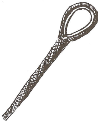
Abb. 34. Richtig gespleißtes Kabel (Litze) mit eingelegter Kausche.
